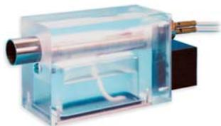
Измерения: Температура по сухому термометру, температура по влажному термометру, относительная влажность, атмосферное давление, точка росы, абсолютная влажность, смесь, энтальпия, давление пара
